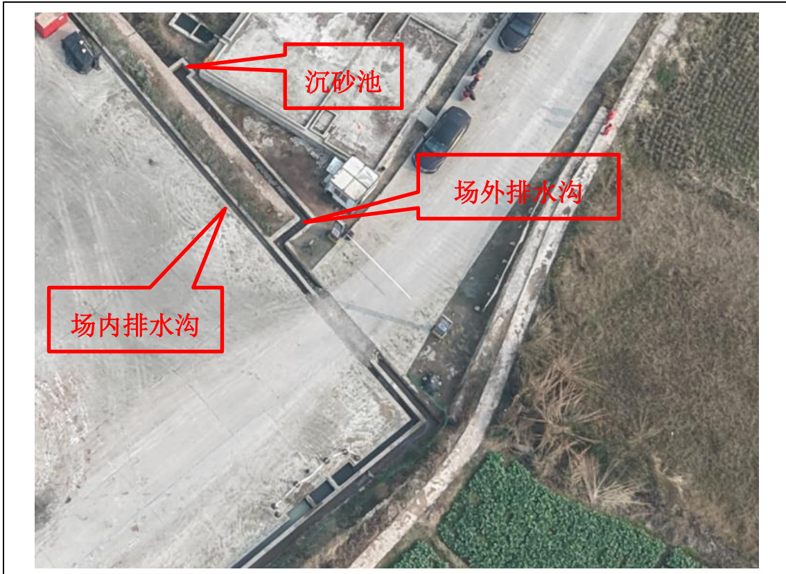
主体工程防治区-排水沟、沉砂池措施
